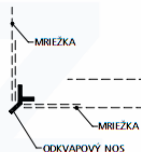
SCHÉMA PREKRÝVANIA VÝSTUŽNEJ MREŽKY
